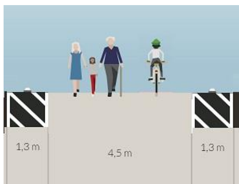
Rysunek 4. Przykładowy przekrój z zaznaczeniem stref ruchu na kładce pieszo-rowerowej 6 .
