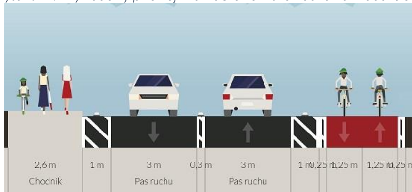
Rysunek 2. Przykładowy przekrój z zaznaczeniem stref ruchu na wiadukcie 5 .
